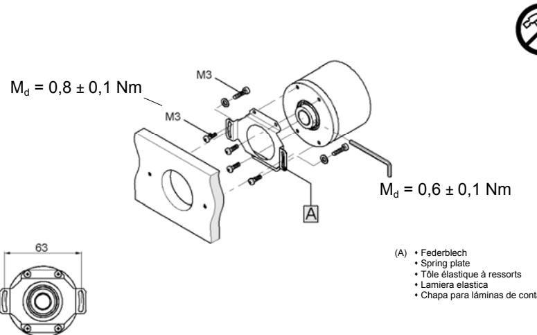
B Federblech, Hohlwelle • Spring plate, hollow shaft • Tôle élastique à ressorts, arbre creux • Lamiera elastica, albero cavo • Chapa para láminas de contacto, eje hueco
